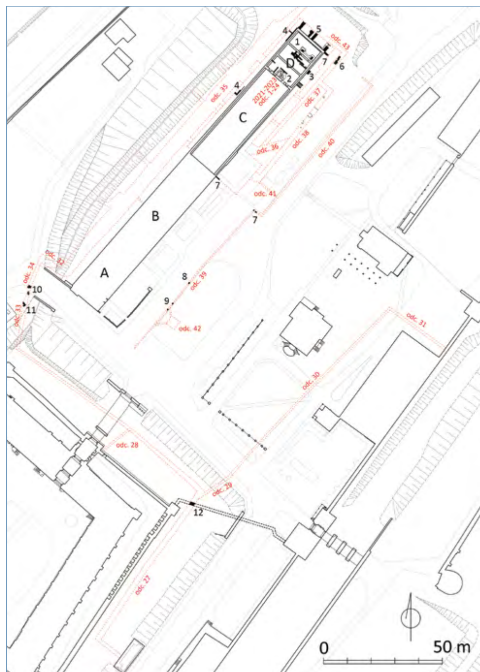
Ryc. 1 Plan części zamku z zaznaczeniem objętych nadzorem wykopów liniowych pod przyłącza instalacji na terenie przedzamcza oraz odkrytych relikwów murów: 1 – fundamenty filarów komina i ścian działowych w budynku D, 2 – pozostałości kanałów piecowych i ścian działowych w budynku D, 3 – kosz okna piwnicznego, 4 – fundamenty przybudówek zachodnich, 5 – gotyckie piwnice po północnej stronie budynku D, 6 – fundament muru ogrodzenia podwórza i przyległego budynku gotyckiego, 7 – fundamenty murów ogrodzenia podwórza, 8 – fundament północnej ściany gotyckiego budynku poprzecznego, 9 – fundamenty ścian kostnicy, 10 – fundament południowego muru szyi bramnej oraz domu z XVIII w. (?), 11 – fundament domu z początku XIX w., 12 – fundament muru fortecznego (rys. B. Wasik).
