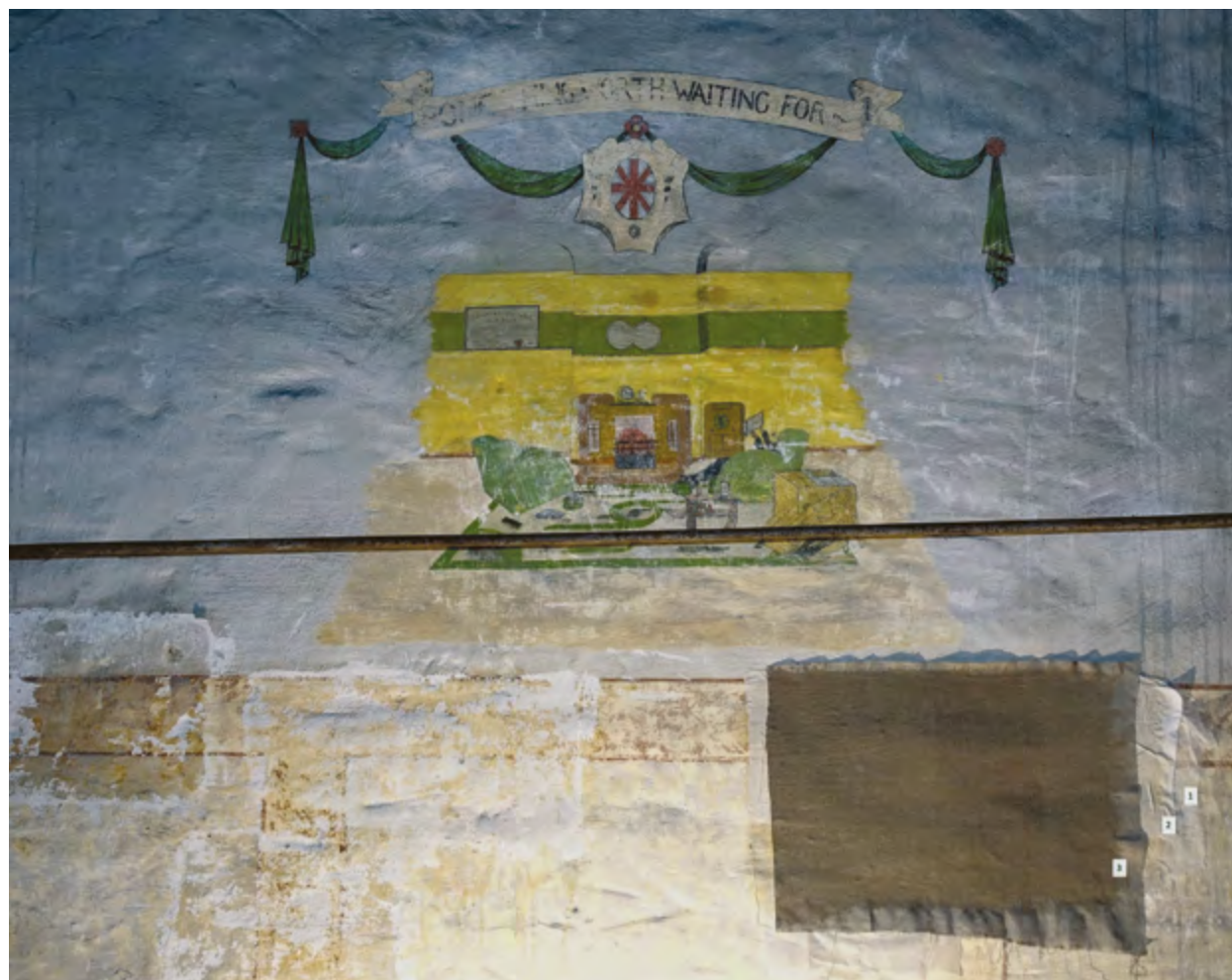
Ryc. 6 Próby licowania: 1. bibuła japońska, 2. sprane płótno bawełniane, 3. płótno lniane
